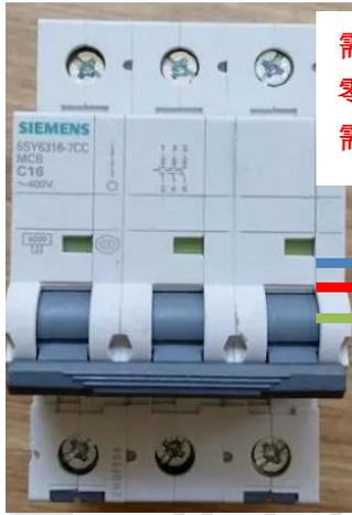
需独立C32空开, 不接漏电保护, 零地电压 < 5V。空开和UPS接线需10mm<sup>2</sup>铜线。
