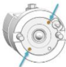
图25: 松开泵压头后部的螺钉
